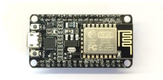
Fig 4.1 Node MCU ESP8266
